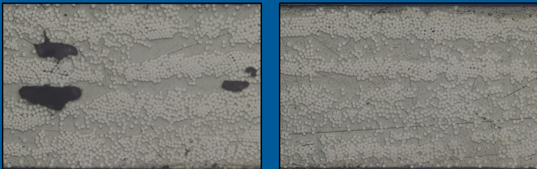
Abbildung: Schliffbild Organoblech, Bild links: unvollständig imprägniert, Bild rechts: vollständig imprägniert
