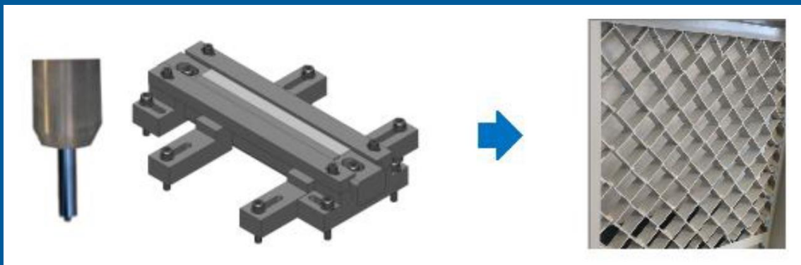
Abbildung 3: Werkzeug inkl. Aufspannung und Leichtbaustruktur
