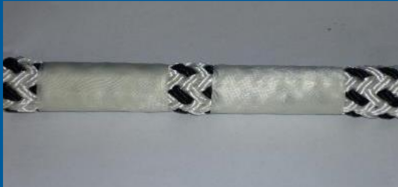
Abbildung 2: mittels Wickelgerät erzeugte Seilabschnitte
