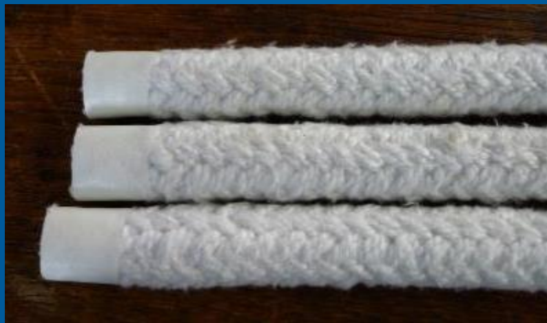
Abbildung 3: Schnittenden Glasfaserseil (Durchmesser 20 mm)
