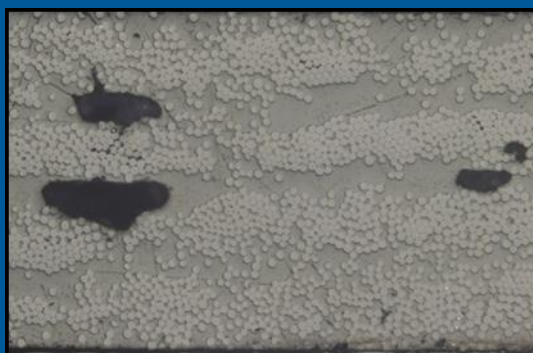
Abbildung: Schliffbilder von Organoblechen links: unzureichend imprägniert
