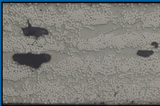
Abbildung: Schliffbilder von Organoblechen links: unzureichend imprägniert
