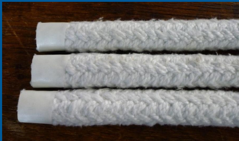
Abbildung 3: Schnittenden Glasfaserseil (Durchmesser 20 mm)
