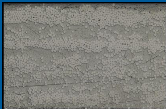
rechts: vollständig imprägniert
