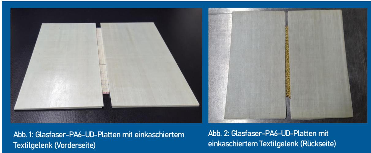
Abb. 1: Glasfaser-PA6-UD-Platten mit einkaschiertem Textilgelenk (Vorderseite)
