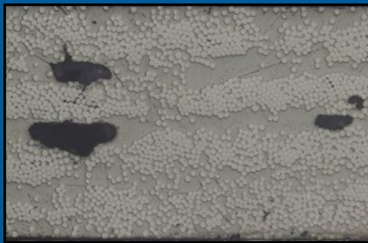
Abbildung: Schliffbilder von Organoblechen links: unzureichend imprägniert
