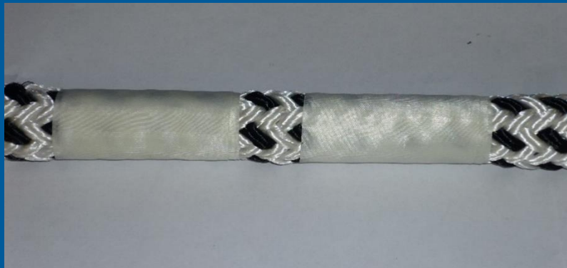
Abbildung 2: mittels Wickelgerät erzeugte Seilabschnitte
